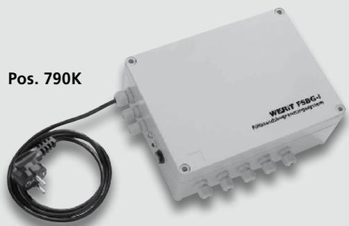
Das Füllstandsbegrenzungssystem WERIT FSB schützt eine Batterietankanlage sicher und zuverlässig vor Überfüllung. Dabei wird nicht nur der 1. Tank durch einen Grenzwertgeber überwacht, sondern jeder einzelne Tank der Anlage. Es ist für neue doppelwandige Tankanlagen und zur Nachrüstung von bestehenden Tankanlagen einsetzbar.
