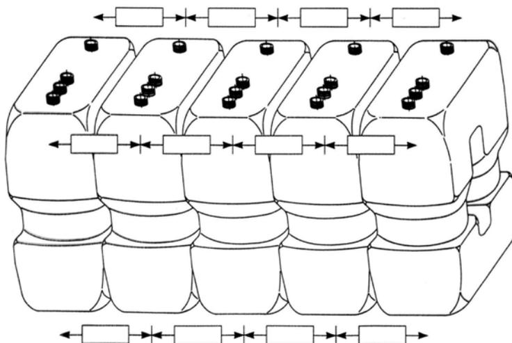
Bitte geben Sie uns bei der **Bestellung von Fülleitungen** immer die Tankmittenabstände und lichte Höhe vom Tankstutzen bis zur Kellerdecke an.
