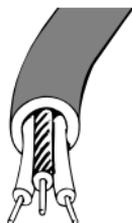
Um Feuchtigkeit in der Klemmendose zu vermeiden, muss der gesamte Kabelumfang in der Kabelbefestigung festgehalten werden. Es müssen daher grundsätzlich runde Kabel verwendet werden, da nur diese sicher abgedichtet werden können.
